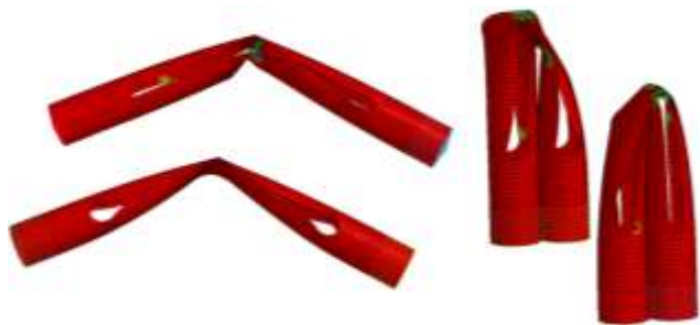
Рис.14. Результаты расчета УШ с учетом прогрессирующего разрушения в LS-Dyna
