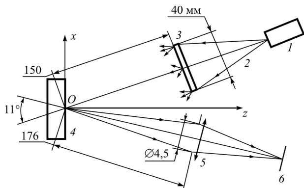
Рис. 2. Схема оптической установки: 1 – лазерный модуль; 2 – освещающее излучение; 3 – матовое стекло; 4 – образец; 5 – линза с диафрагмой; 6 – матрица фотоэлементов телекамеры
