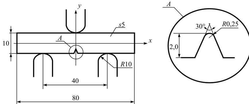
Рис. 1. Форма образца, его размеры и схема нагружения
