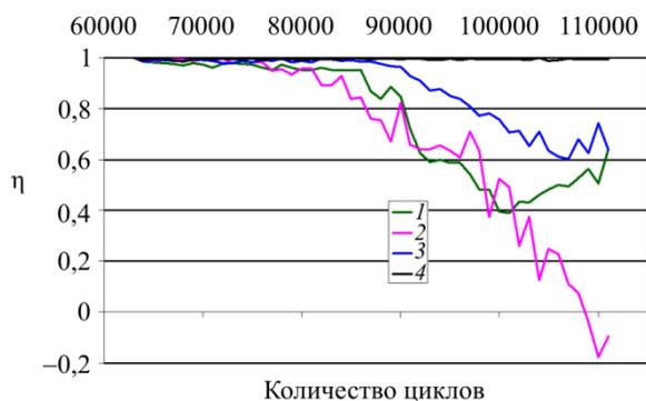
Рис. 6. Зависимости  $\eta(N)$  для четырех фрагментов спекловых изображений, соответствующих: 1 – центру утяжки; 2 – склону утяжки; 3 – вершине надреза; 4 – участку вдали от надреза
