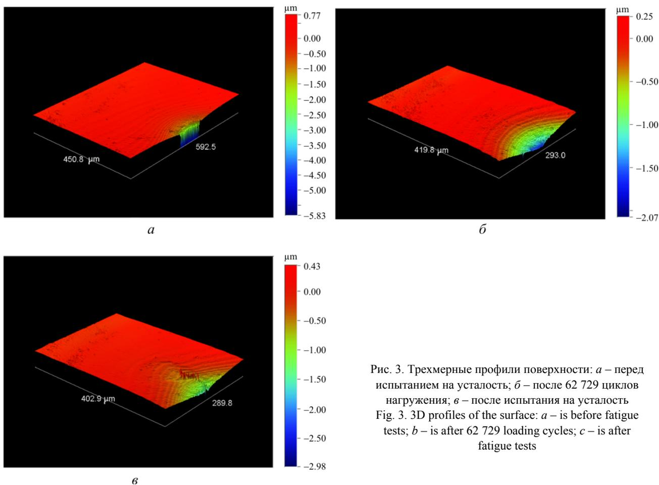
Рис. 3. Трехмерные профили поверхности: а – перед испытанием на усталость; б – после 62 729 циклов нагружения; в – после испытания на усталость
