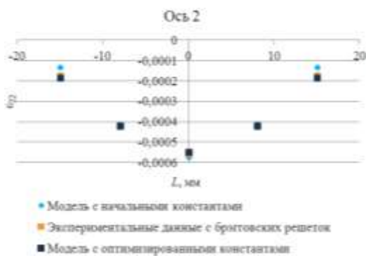
Рис. 8. Сравнение значений деформаций \epsilon_{22} , полученных из расчета модели с использованием начальных констант (♦), при помощи оптоволоконных датчиков (■) и из расчета модели с использованием оптимизированных констант (■);
