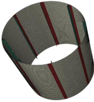
Рис. 2. Конечно-элементная модель цилиндрической оболочки с ребрами
