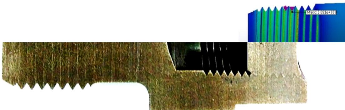
Рис. 13. Сопоставление реального разрушения и модели МКЭ
