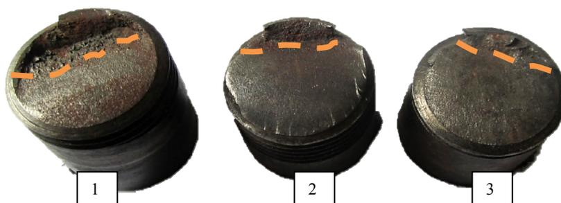
Рис. 2. Общий вид поверхностей разрушения штоков насосных. Штриховыми линиями показаны зоны долома
