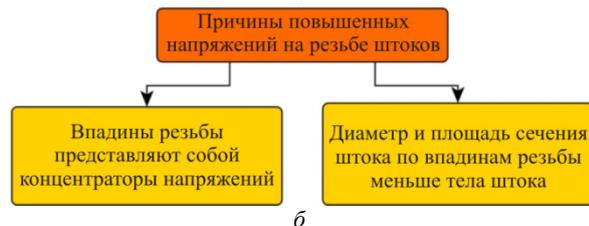
Рис. 4. Сопряжение штока с переходником штока (а); причины повышенных напряжений на резьбе штоков (б)
