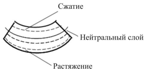
Рис. 2. Схема деформирования слоев в одном элементе пластины
