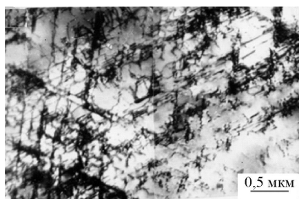
Рис. 2. Электронно-микроскопические изображения двухфазности в сплаве с концентрацией марганца от 0,4 до 6 ат. %: сетчатая и разориентированная ячеисто-сетчатая ДСС ( \epsilon_{\text{ист}} = 0,20 )
