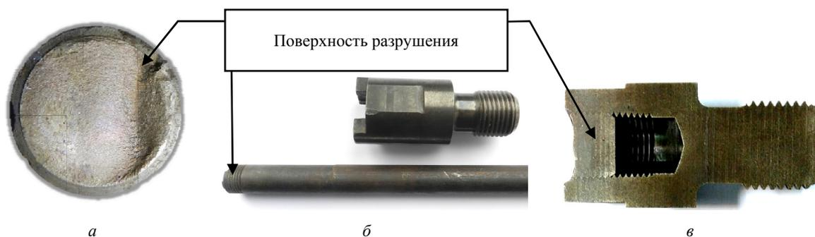
Рис. 1. Типичный случай разрушения штока по резьбе: а – поверхность разрушения; б – разрушенное резьбовое соединение штока; в – профиль поверхности разрушения на обломке штока внутри переходника
