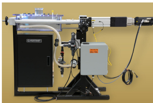
Рис. 7. Образец стенда Cortest для усталостных испытаний в коррозионной среде
