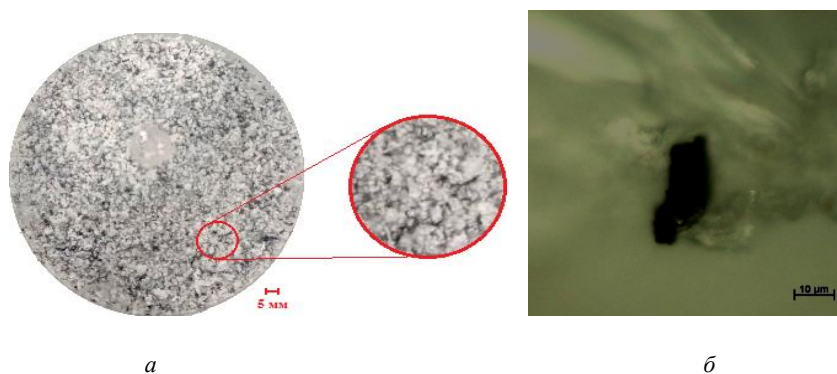
Рис. 4. Внешний вид порошка, полученного по схеме № 2, после спекания: а – общий вид; б – отдельный агломерат
