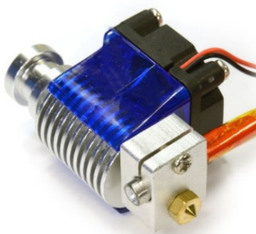
Рис. 1. Стандартный экструдер для FDM/FFF 3D-печати
