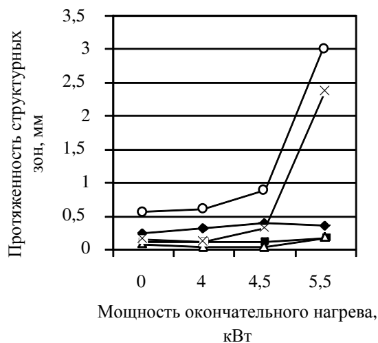
Рис. 6. Влияние мощности окончательного нагрева на протяженность структурных зон сварного соединения: —◆— кристаллизации шва; —■— перегрева; —▲— нормализации; —×— рекристаллизации; —□— разупрочнения
