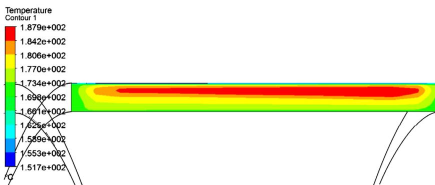
Рис. 6. Поле температуры: винтовой канал, обращенное движение
