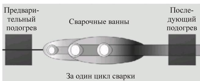
Рис. 7. Схема тепловых полей при сварке чугуна [6]
