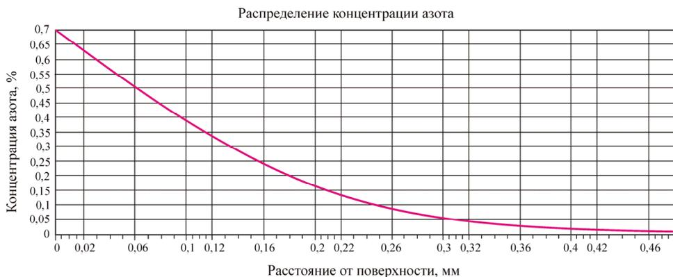
Рис. 2. Расчетная концентрационная кривая азота в нихроме после ионного азотирования (потенциал среды равен 65 %) при температуре 1000 °С в течение 150 ч
