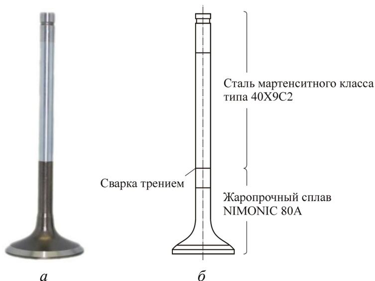
Рис. 1. Конструкция биметаллического выпускного клапана дизельного двигателя: *а* – общий вид [3]; *б* – чертеж [4]
