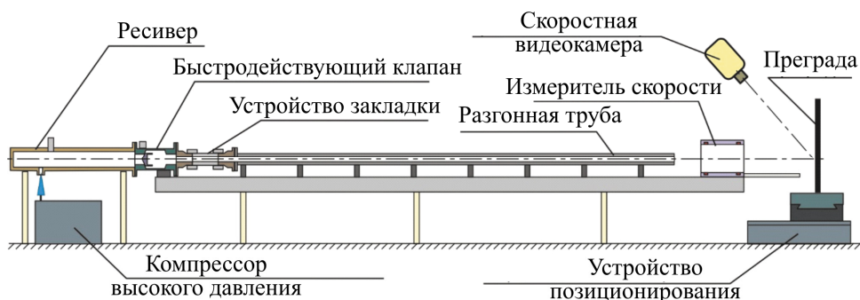
Рис. 1. Схема установки проведения испытаний
