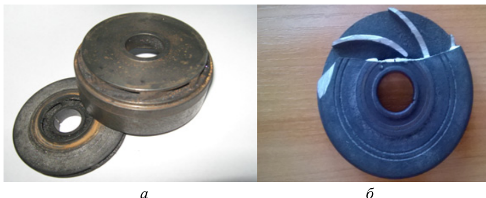
Рис. 1. Детали модуля насоса: «аппарат направляющий» и «колесо рабочее» (а) и разрез детали «колесо рабочее» (б)
