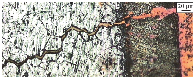
Рис. 2. Межкристаллитное проникновение меди в сталь [5]
