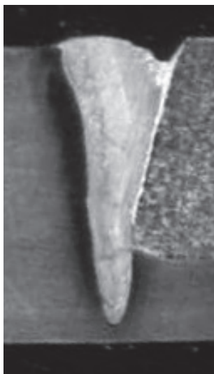
Рис. 4. Сварное соединение: мартенситная сталь 09X16H4Б с бронзой БрХ-08, толщина 7,5 мм
