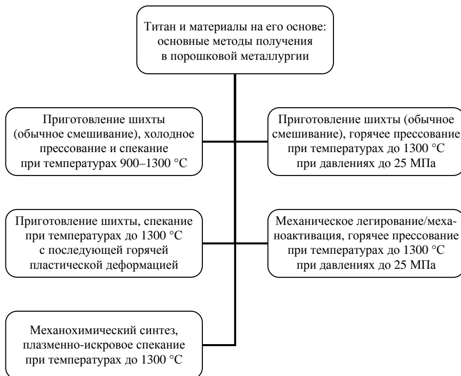
Рис. 1. Основные технологии получения титановых материалов в НЦ ПМ
