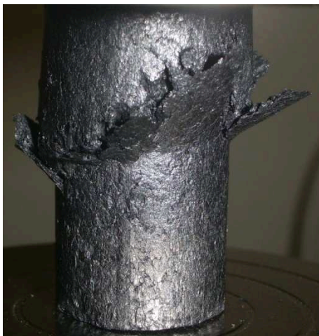
Рис. 4. Отслоение внешнего слоя образца
