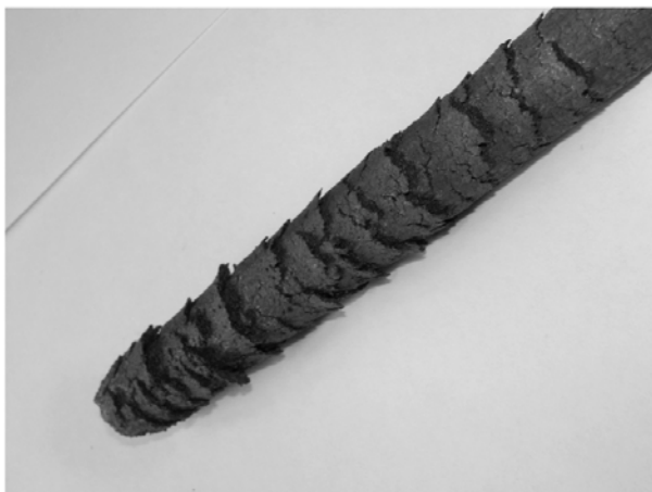
Рис. 2. Экструдированное изделие с поверхностными дефектами
