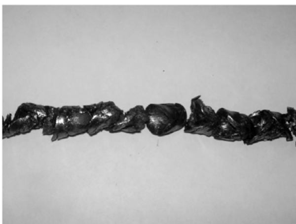
Рис. 3. Деструкция изделия на выходе из фильеры
