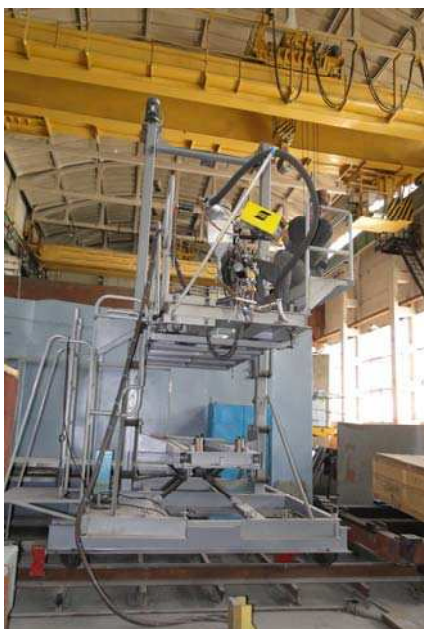
Рис. 3. Рабочая площадка с установленным на ней сварочным трактором А2
