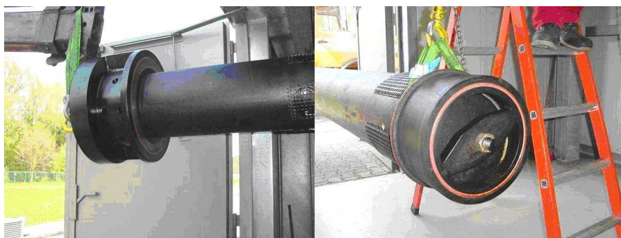
Рис. 13. Вихревая труба после пяти лет испытаний
