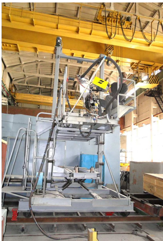
Рис. 2. Рабочая площадка с установленным на ней сварочным трактором А2
