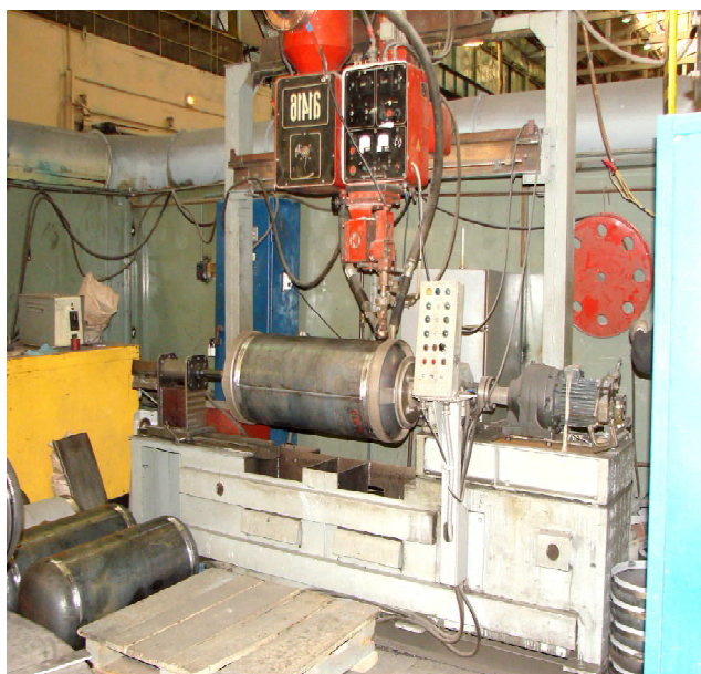
Рис. 1. Установка для автоматической сварки под слоем флюса газовых баллонов
