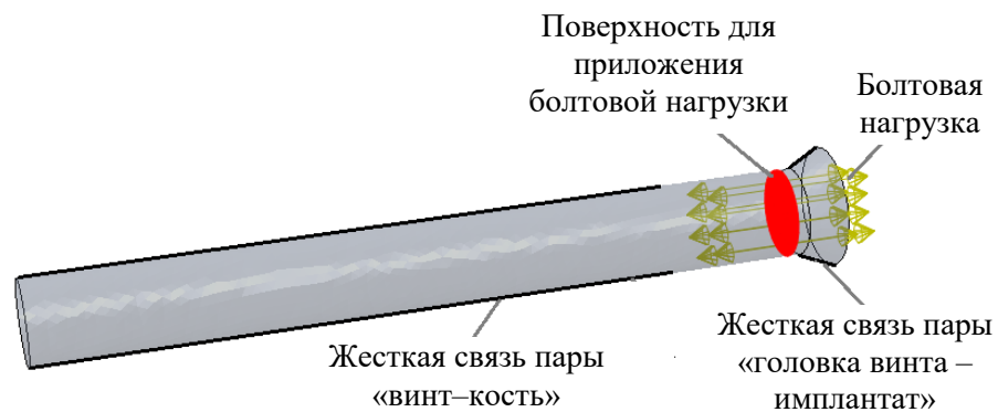
Рис. 8. Демонстрация силовых граничных условий и контактных областей на примере седьмого винта
