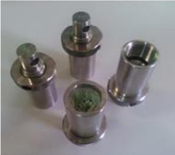
Рис. 3. Оснастка для проведения испытаний тонкими держателями
