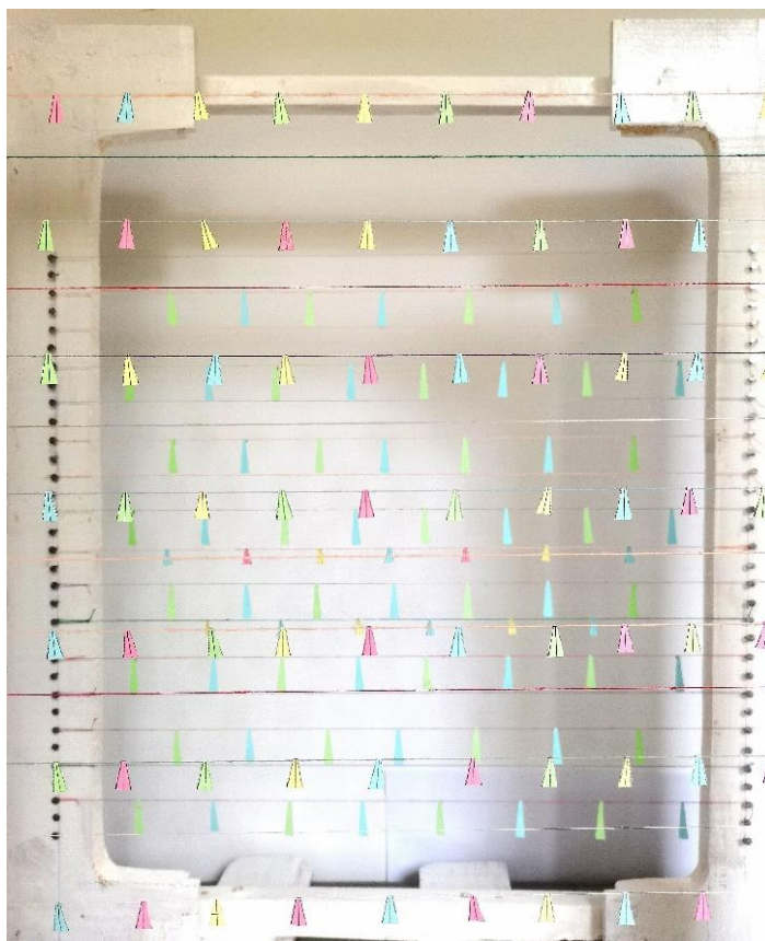
Рис. 1. Анемометрический датчик высокой чувствительности из треугольных бумажных флажков
