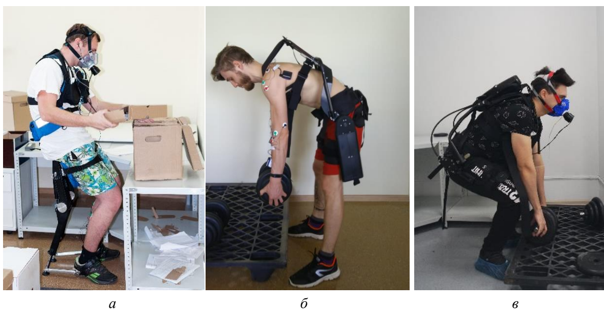
Рис. 1. Образцы прототипов промышленного экзоскелета: а – ППЭ-1; б – ППЭ-2; в – ППЭ-3
