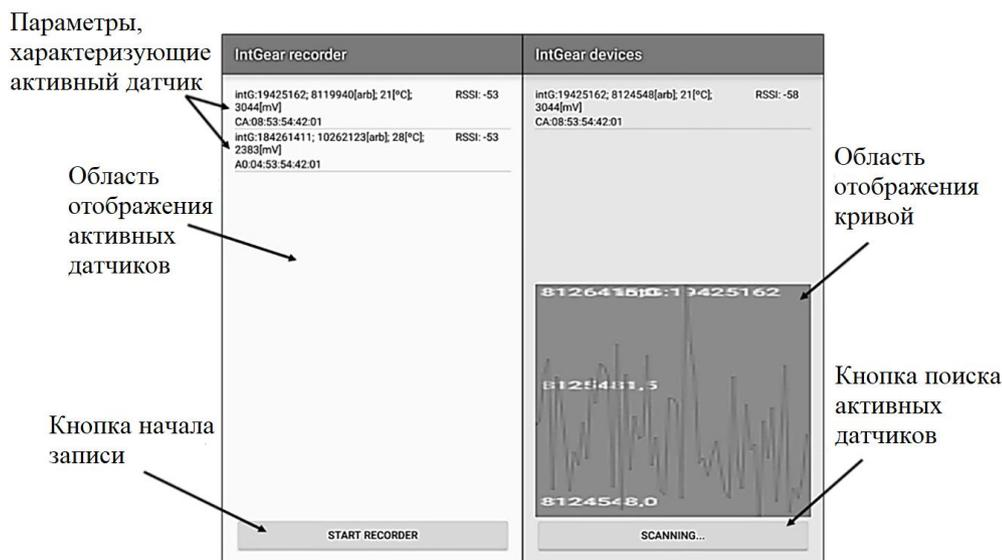
Рис. 4. Интерфейсы приложений *IntGear recorder* и *IntGear devices*
