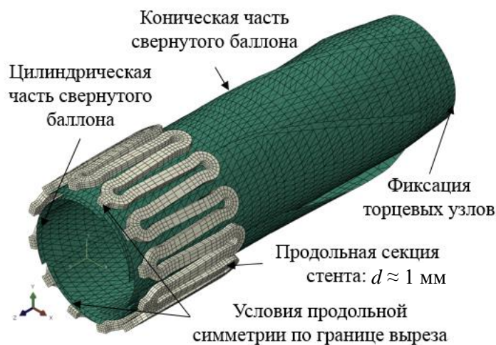
Рис. 4. Расчетная схема: свободное раскрытие секции стента
