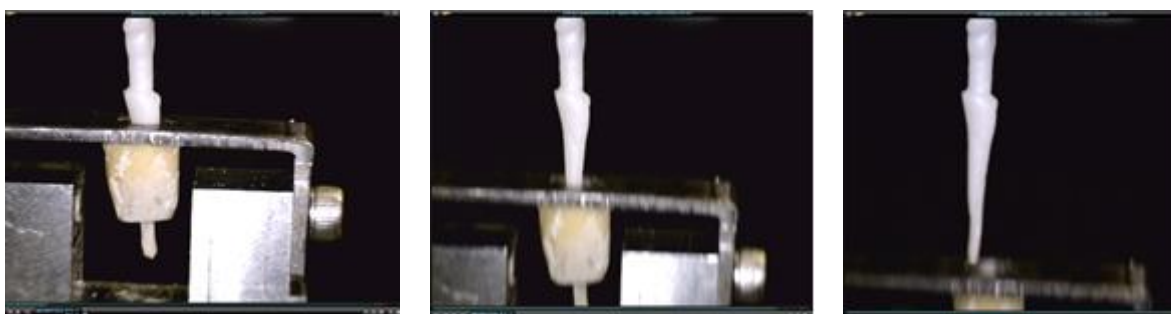
Рис. 4. Последовательный процесс вытягивания имплантата из образца
