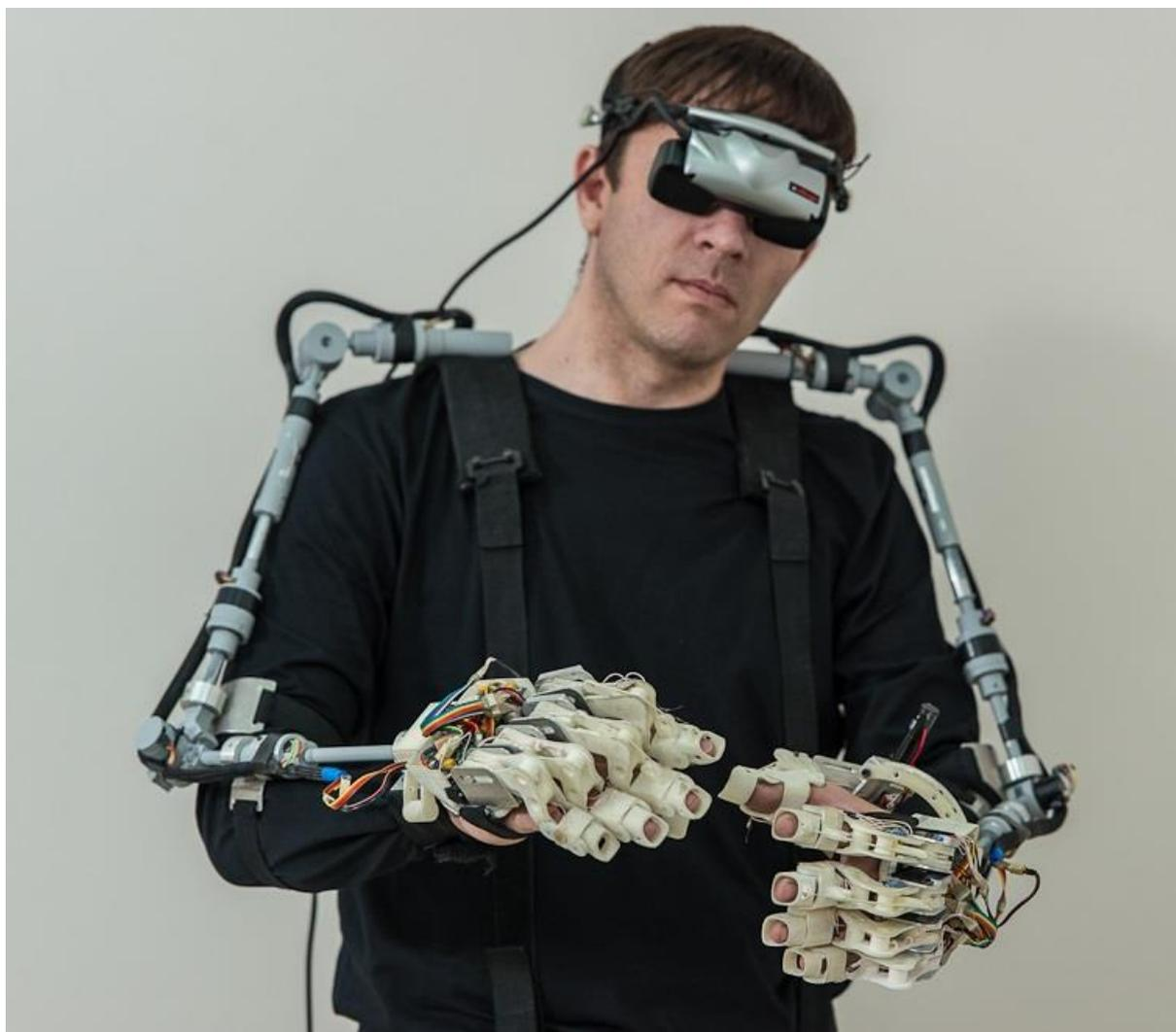
Рис. 1. Костюм копирующего типа с обратной силомоментной связью «Аватар» [15]
