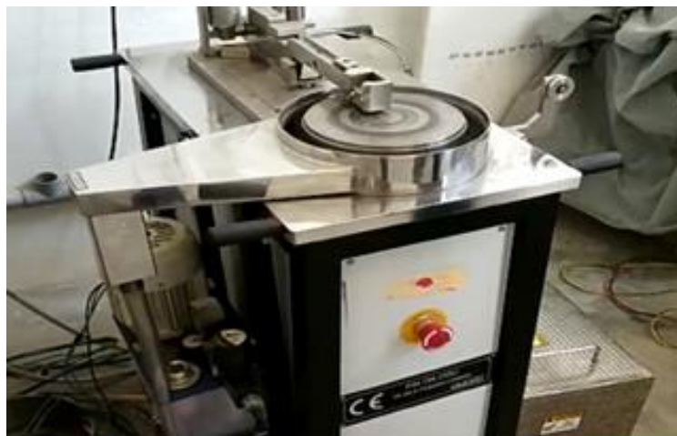
Рис 4. Трибومتر для испытания с геометрией контакта «штифт–диск»
