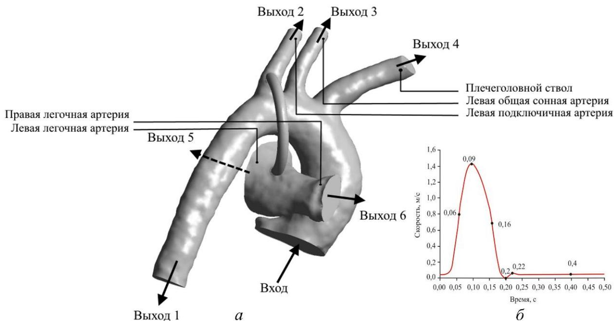
Рис. 6. Граничные условия: *a* – граничные условия в системе «аорта–легочная артерия», *б* – профиль скорости на входе
