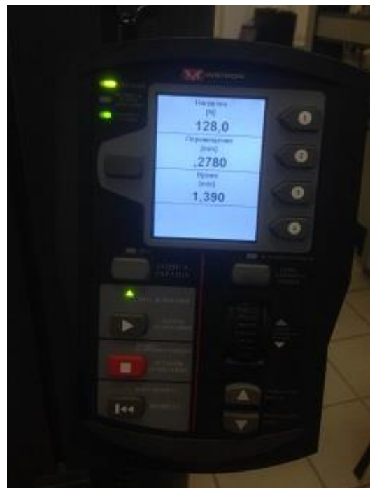
Рис. 4. Регистрирующий дисплей. Показаны значения нагрузки (Н), перемещения (мм) и времени (с)
