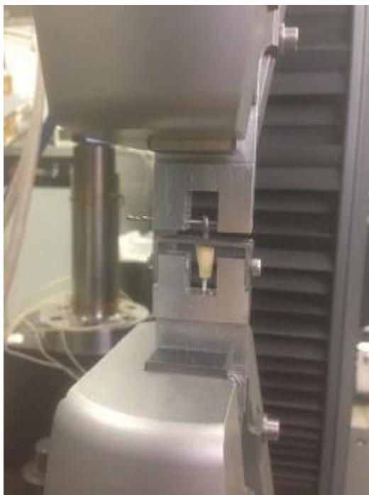
Рис. 3. Установка Instron 5900 с образцом в оснастке во время испытаний на растяжение
