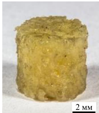
Рис. 1. Образец после сжатия на 8%
