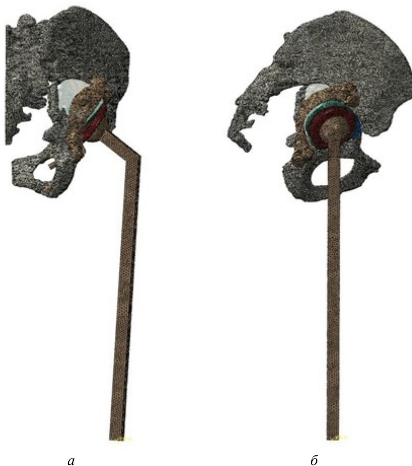
Рис. 5. Расчетная модель биомеханической системы «скелет – эндопротез»: а – вид спереди; б – вид справа
