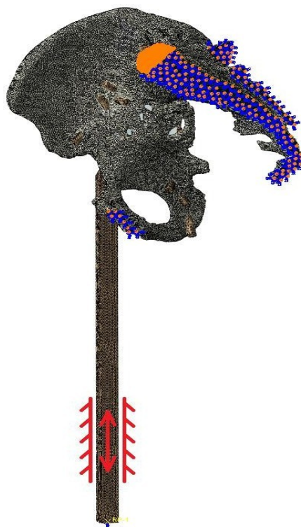
Рис. 6. Граничные условия, наложенные на модель
