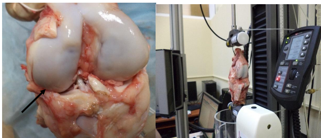
Рис. 1. Препарат «сустав – имплантат» и его тестирование (стрелкой показан имплантат)
