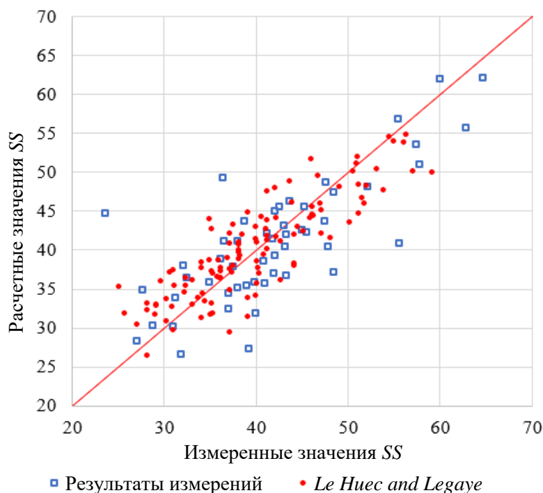
Рис. 7. Сравнение измеренных значений SS и рассчитанных по формуле (3)
