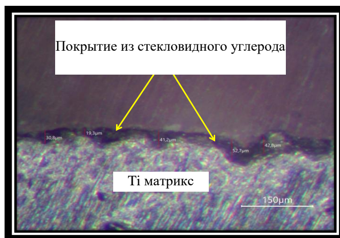
Рис. 4. Микроструктура высокошероховатого стеклоглеродного покрытия, нанесенного на пористый титановый сплав (поперечное сечение)
