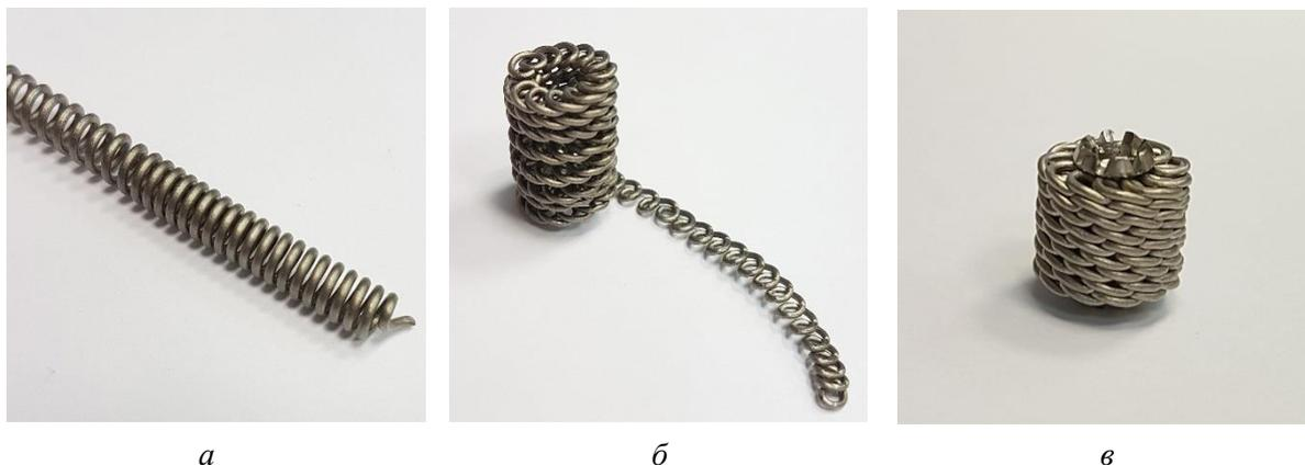
Рис. 1. Этапы изготовления пористой заготовки из титановой проволоки: *а* – исходная спираль из проволоки; *б* – расплющенная полоса из спирали навивкой во вторичную спираль; *в* – готовый имплантат
