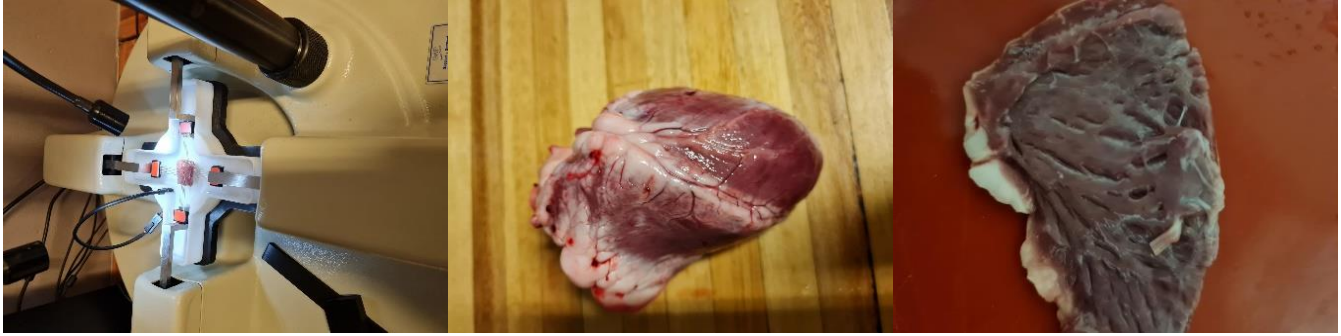
Рис. 1. Экспериментальная установка для равноосного механического испытания сердца овцы для трех различных областей, включая левый желудочек, межжелудочковую перегородку и правый желудочек
