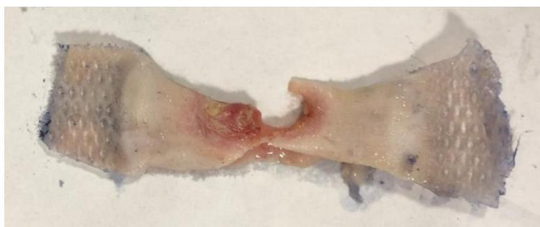
Рис. 3. Образец кожи после испытания на растяжение
