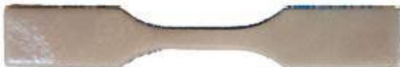
Рис. 1. Трафарет для изготовления образцов
