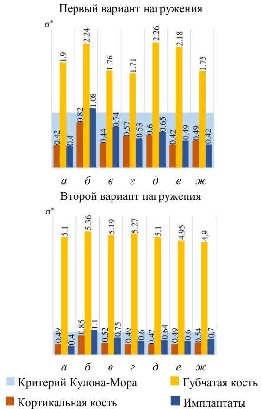
Рис. 8. Максимальные значения относительного напряжения для схем нагружения, представленных первым и вторым вариантами нагружения
