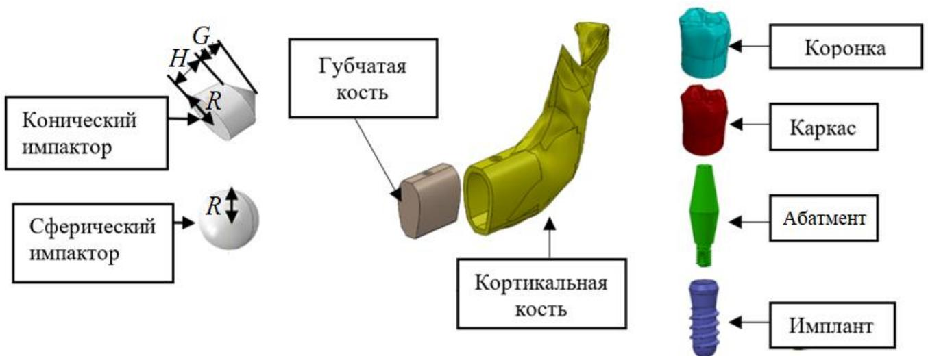
Рис. 3. Компоненты зубного протеза и формы импактора
