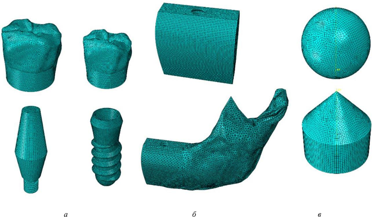
Рис. 4. Сетка из различных частей: компоненты зубного протеза (а); части кости (б), форма импактора (в)
